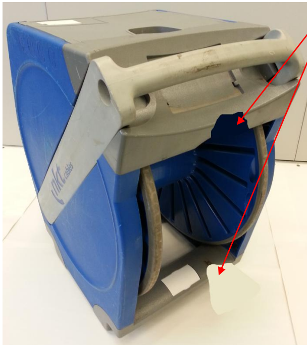
Poškozená vnější konstrukce QADDY
