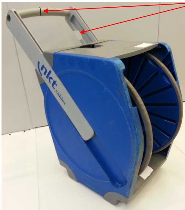
Poškozené madlo (úloemek, prasklina...)
